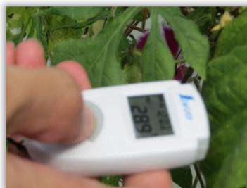
放射温度計での葉温測定
